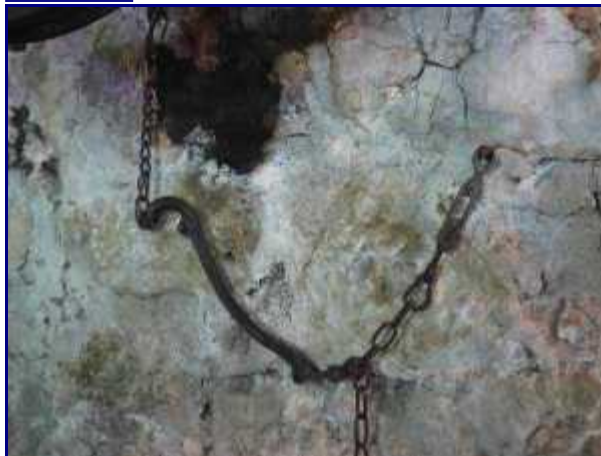
Le régulateur de débit d'eau. Archaïque mais très efficace !
