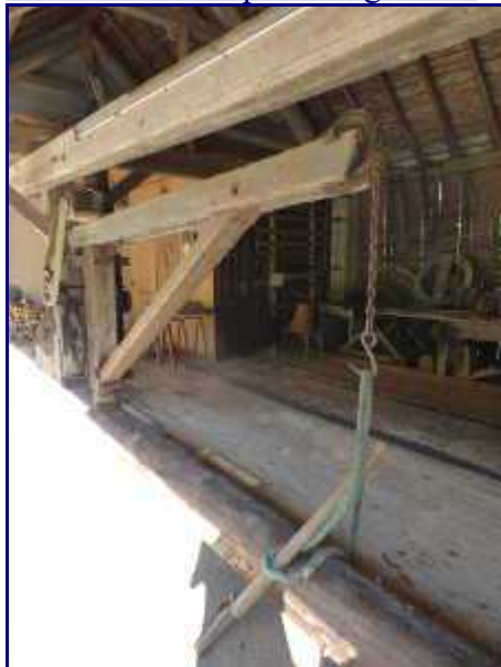
Potence pour l'installation des troncs sur la scie.
