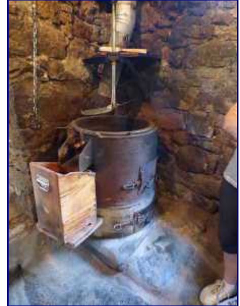
La chaudière pour chauffer un peu les noix broyées.
