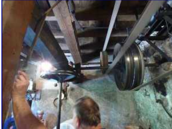
La manivelle de changement de poulie pour changer de travail.
