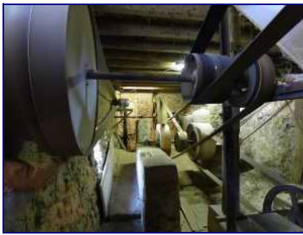
Le système de courroies / pignons qui démultiplie le mouvement.
